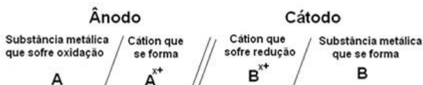
Figura 2 – Convenção mundial de representação das pilhas
