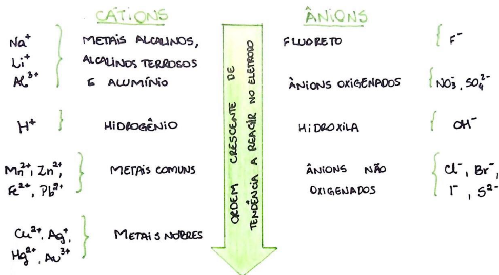
Figura 10 – prioridade de descarga dos elementos
